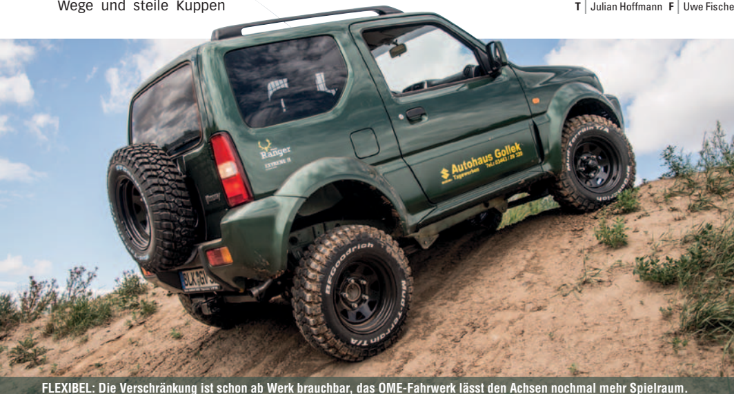
FLEXIBEL: Die Verschränkung ist schon ab Werk brauchbar, das OME-Fahrwerk lässt den Achsen nochmal mehr Spielraum.
