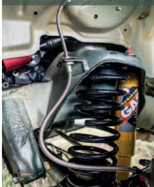
SAFETY FIRST: Verlängerte Stahlflex-Bremsleitungen sind ein Muss.
