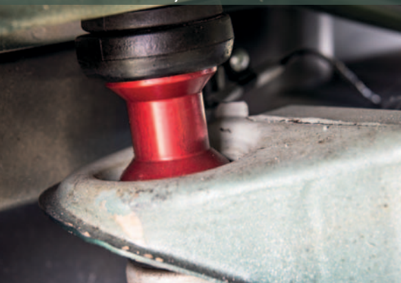
HÖHENGEGWINN: Das Bodylift-Kit hebt die Karosserie um 50 mm.
