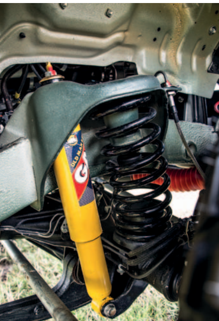
KOMPLETT-LÖSUNG: Dämpfer und Feder kommen von Old Man Emu und bringen ca. 50 mm.
